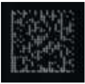
Laserdirektkennzeichnung auf einer Faltschachtel (ISO/IEC 15415 Beleuchtung)
