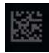
Laserdirektkennzeichnung auf eloxiertem Aluminium, ISO/IEC 15415 Beleuchtung
