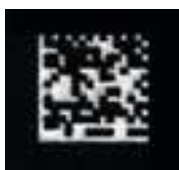
Laserdirektkennzeichnung auf glattem Kunststoff (ISO/IEC TR 29158 DPM Beleuchtung)
