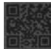
Laserdirektkennzeichnung auf Spanplatte, ISO/IEC 15415 Beleuchtung
