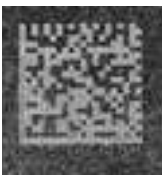
Laserdirektkennzeichnung auf einer genarbtten Kunststoffoberfläche (ISO/IEC TR 29158 Beleuchtung)
