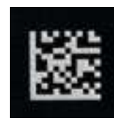
Laserdirektkennzeichnung auf eloxiertem Aluminium, DPM Beleuchtung
