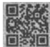
Laserdirektkennzeichnung auf Spanplatte, DPM Beleuchtung
